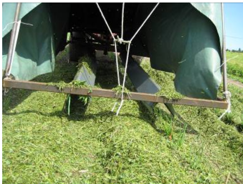
Foto 7. Spridningsutrustning för vallklipp som marktäckning i grönsaksodling
